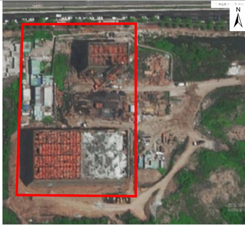
一期建设内容：1座10层厂房A、1座12层宿舍、门卫室、路面及车库、绿地，总建筑面积44166.72m<sup>2</sup>，厂房A建筑面积36485.98m<sup>2</sup>，基底面积3210.41m<sup>2</sup>；宿舍建筑面积7656.74m<sup>2</sup>，基底面积644.12m<sup>2</sup>。
